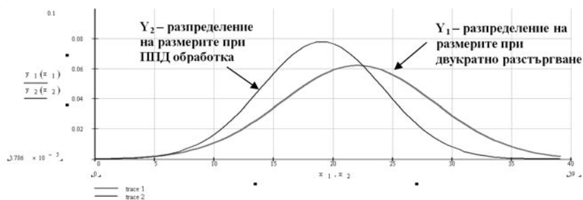
Фиг. 5. Разпределение на плътността на вероятностите по нормалния закон на размерите на отвора на втулката, обработен посредством: Y_1 – двукратно разстъргване, Y_2 – ППД обработка.
