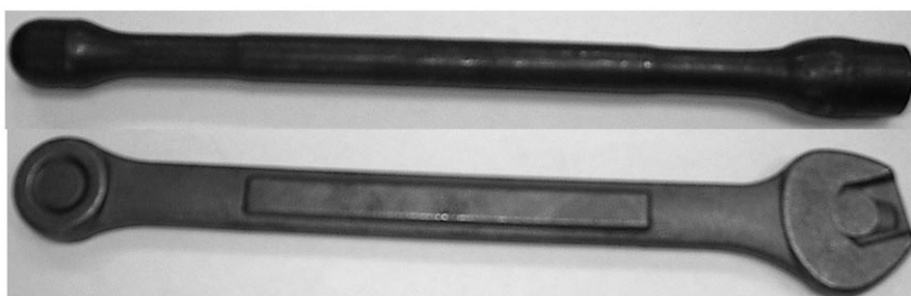
Рис. 1. Переходы изготовления поковки ключа гаечного двухстороннего
