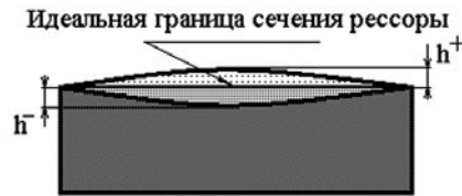
Рис. 7. Макро-отклонение формы сечения в виде трапеции, вызываемое бочкообразным профилем прокатного вала
